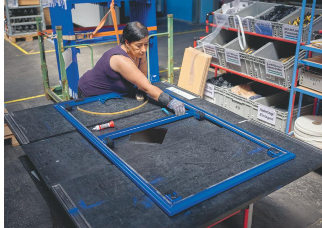
Im Werk in Matrei werden auch Halbfabrikate wie etwa die Installationsrahmen für die Setaplano Duschflächen produziert.
