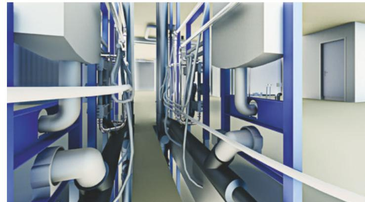
Im Building Information Modelling (BIM) kann die Installation in 3D visualisiert werden.
